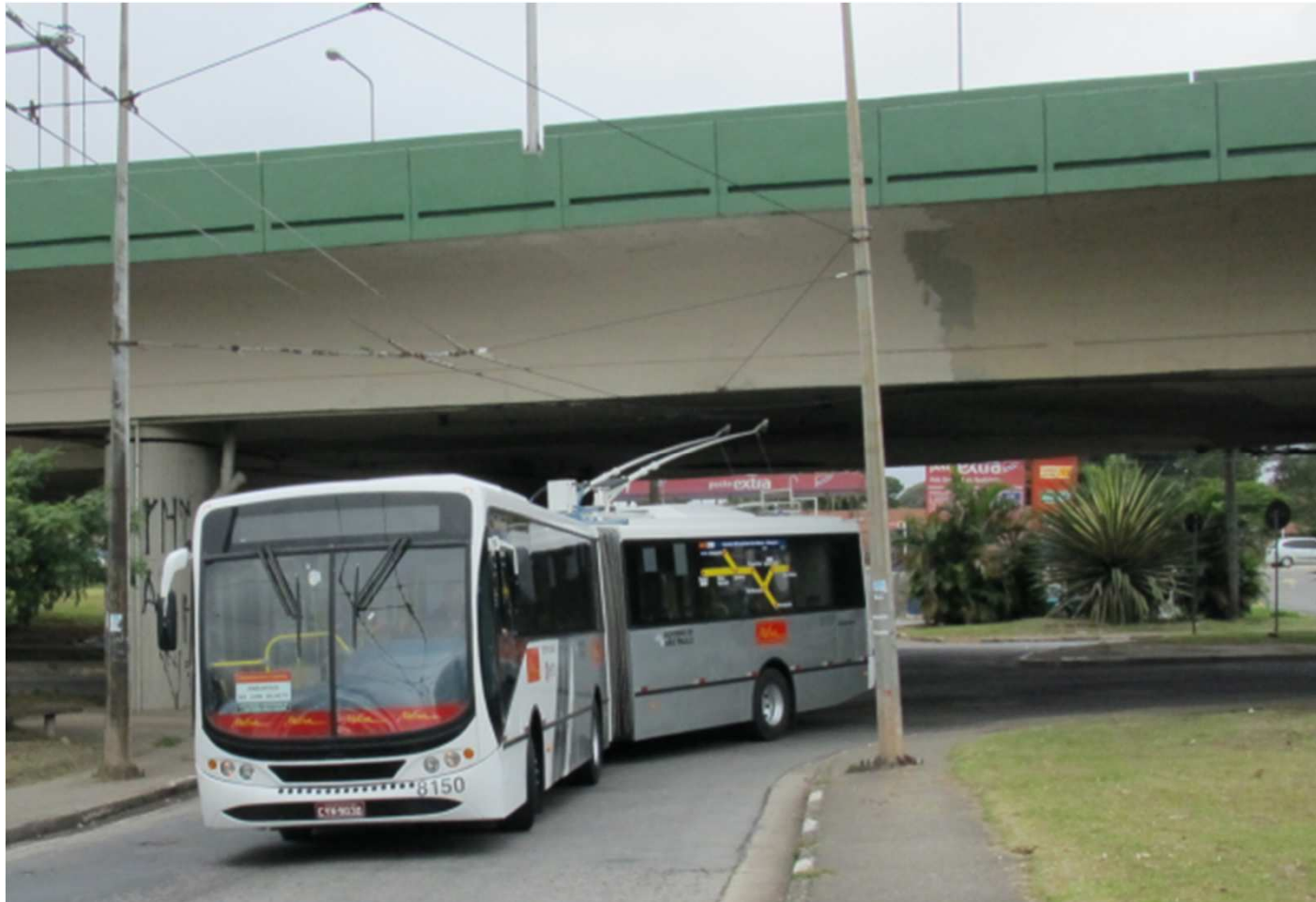
Trólebus Articulado 18 metros, com motor e inversor tração WEG 210kW 6P.
